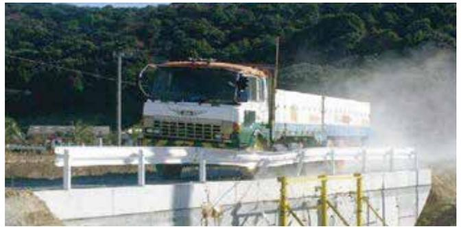
補強土壁工天端上設置時の実車衝突試験
